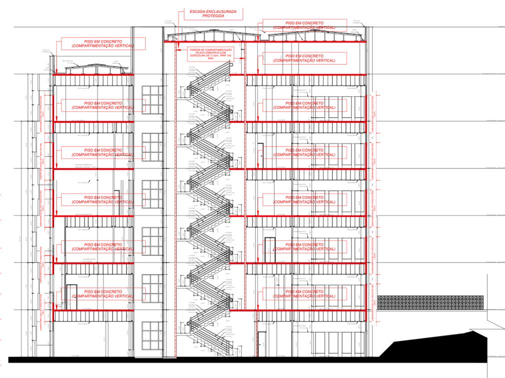
3 DETALHE DA COMPARTIMENTAÇÃO HORIZONTAL E VERTICAL EM CORTE 4
